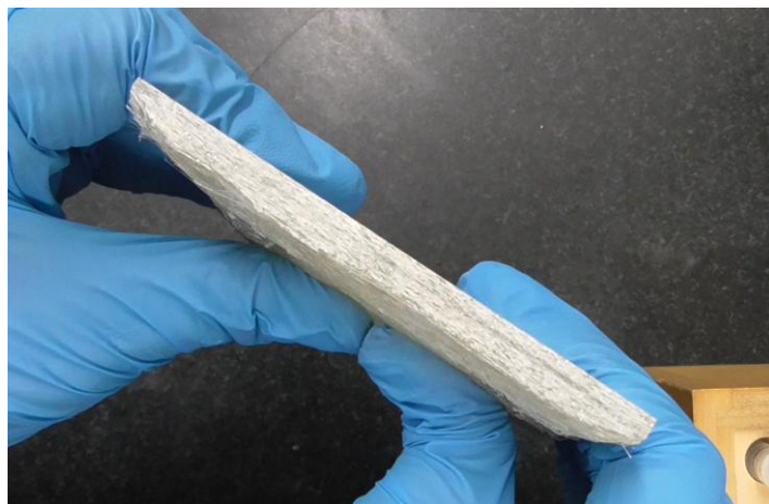
図 定性的曲げ試験の様子（対象試験片：FRP-Dark-PLATE）
