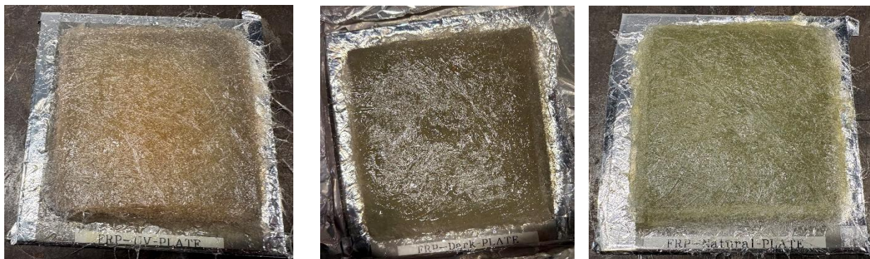
図 硬化後の GFRP 外観
