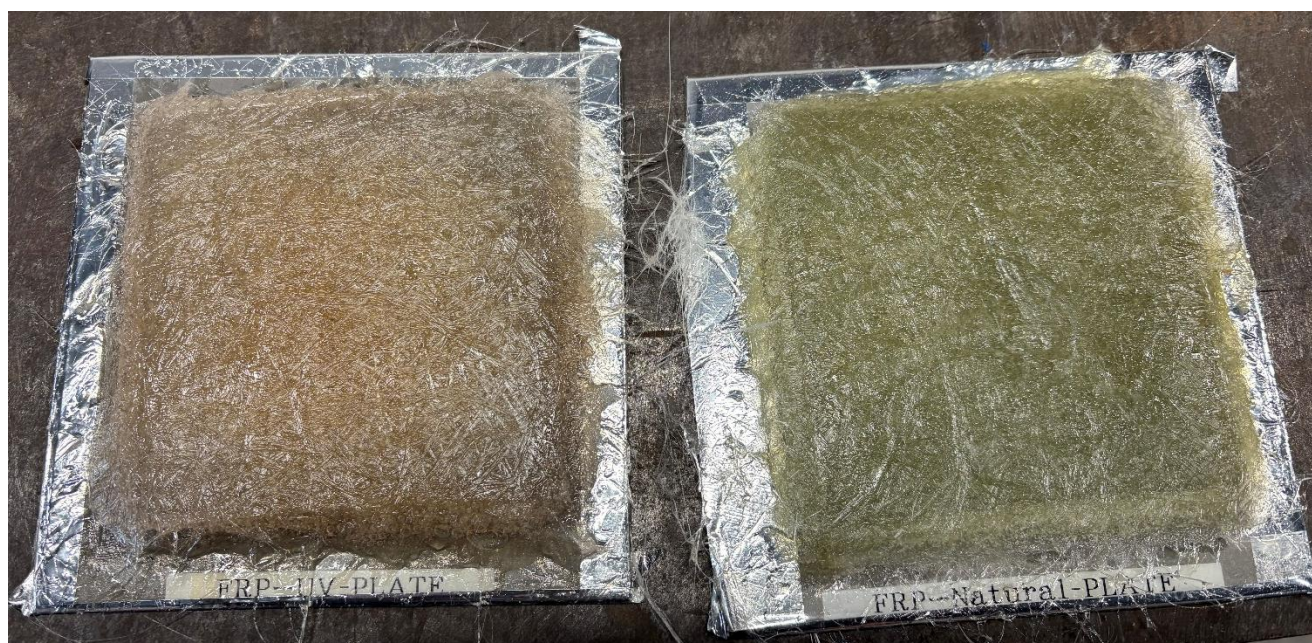
図 褐色に変化した UV 照射で硬化した FRP-UV-PLATE (左) と自然光暴露環境で硬化した FRP-Natural-PLATE (右)
