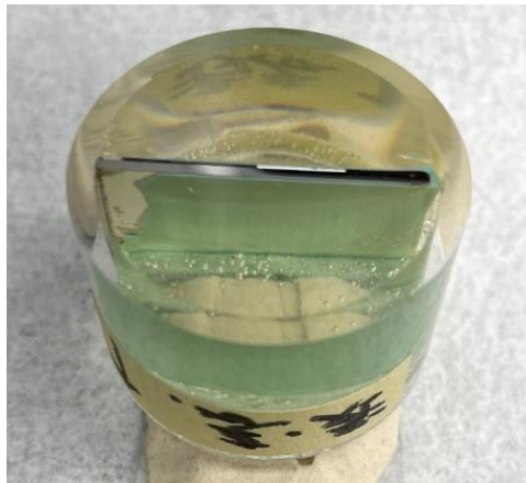
図 樹脂埋めを行った試験片の外観
