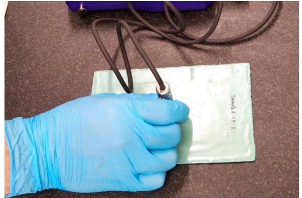
図 塗装膜厚検査の様子
