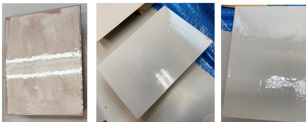
図 フッ素塗装の外観画像（左から、下塗り、中塗り、外塗り後の様子）
