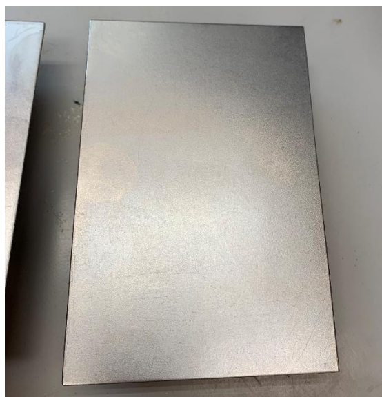
図 評価に用いた SPCC（寸法：150mm×100mm×0.7mm）
