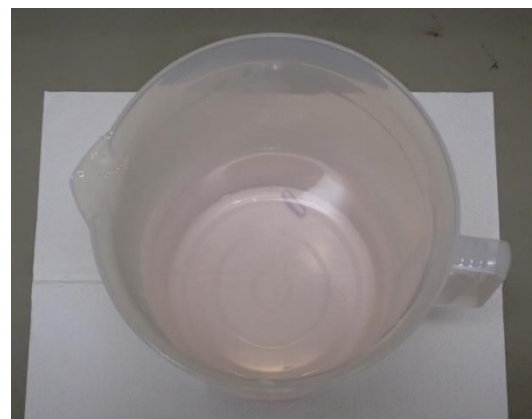
図 FRP 耐食塗装試験片を浸漬した濃塩酸着色の様子
