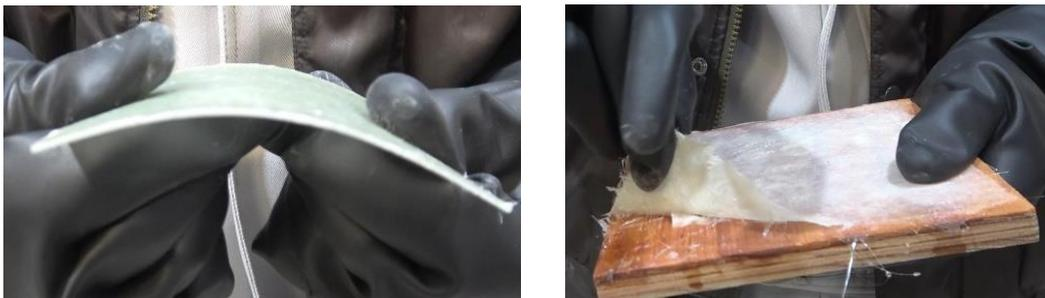
図 正常に硬化した FRP (左) と硬化中の酸性水溶液との接触で硬化不良を起こした FRP (右)
