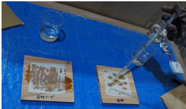
図 ポリエステル不織布にスポイトで水溶液を含浸させている様子
