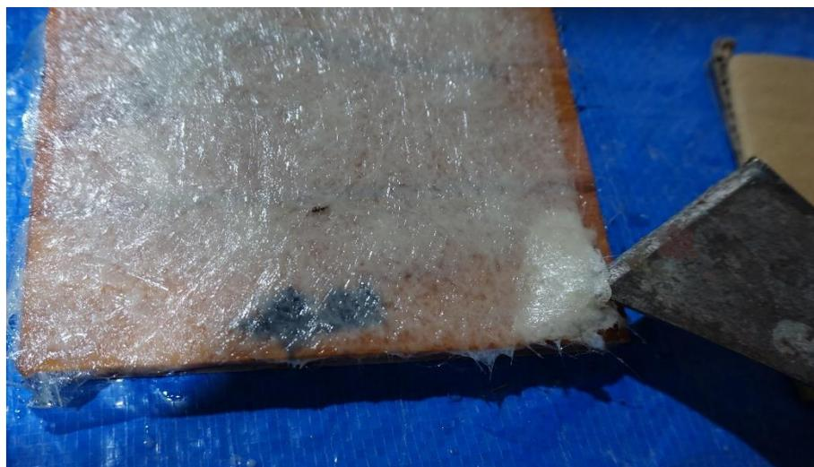
図 酸水溶液接触で硬化していなかった FRP
