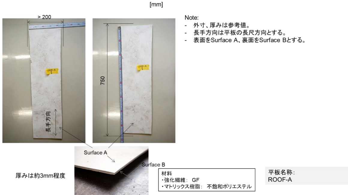
図 FRP 成形体から切り出された平板の概要
