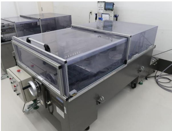
図 試験片加工に用いた複合材料裁断機（左）と試験片加工中の様子（右）
