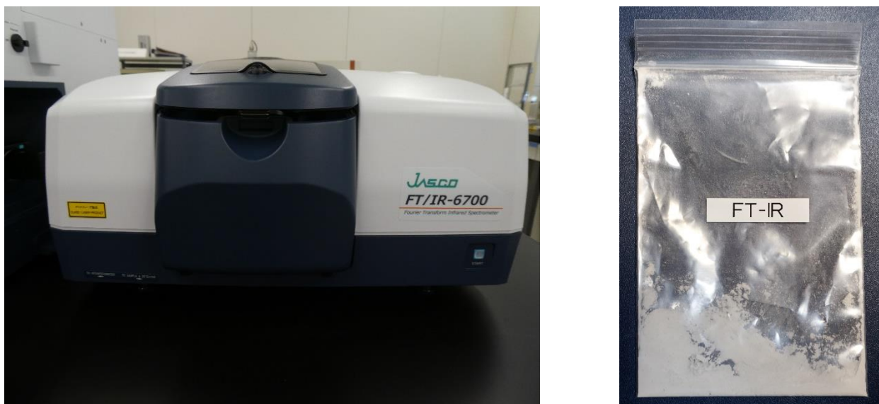
図 フーリエ変換赤外分光光度計（左）と FRP 成形体から採取した評価サンプル（右）
