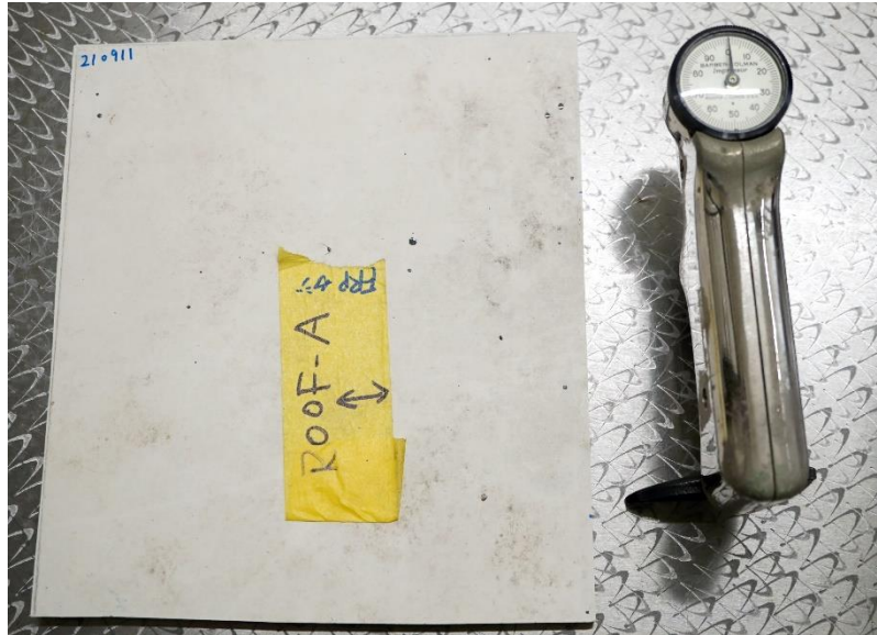
図 使用したバーコル硬度計と評価した平板
