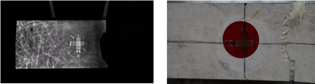
図 引張試験後の破壊領域近辺の X 線 CT 画像と外観写真 (ROOF-A-01)
