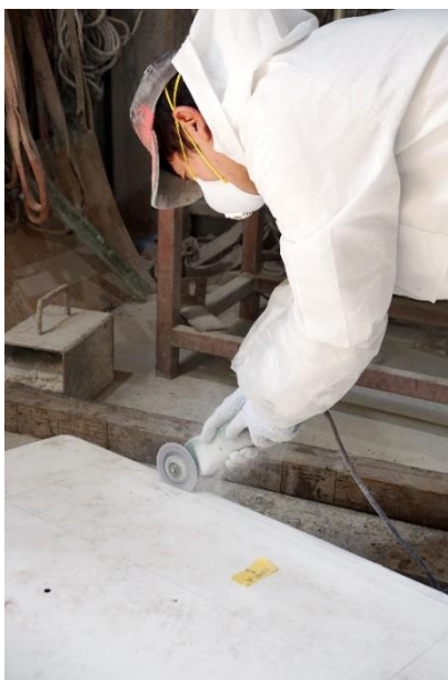
図 FRP 成形体からの切り出しの様子
