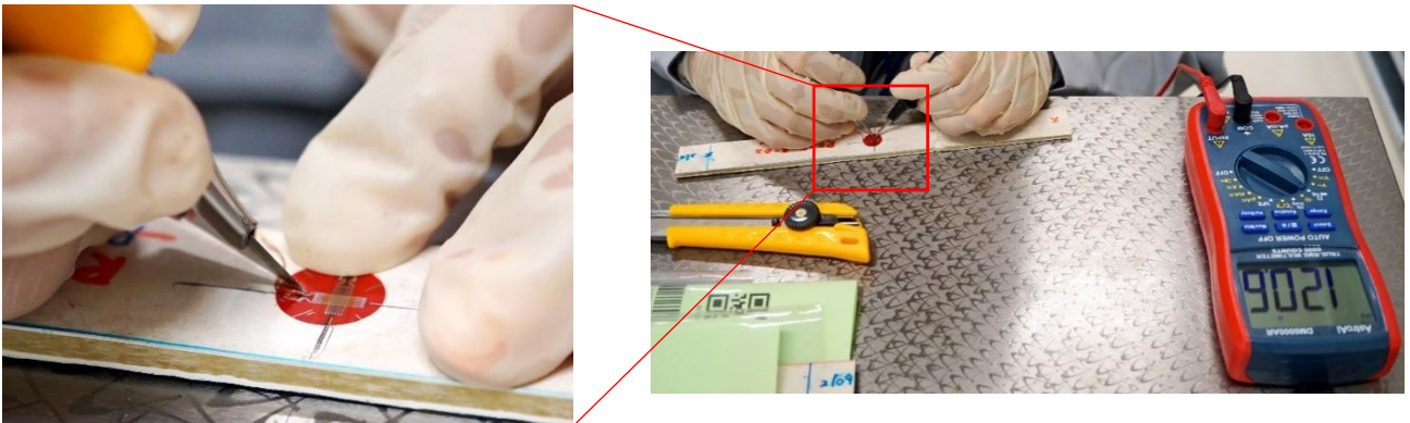
図 デジタルテスターによるひずみゲージ状態確認の様子
