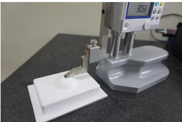
図 ハイトゲージによる寸法測定 (左) と三次元形状測定 (右)
