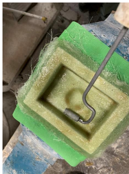
図 生産型に FRP を積層する様子
