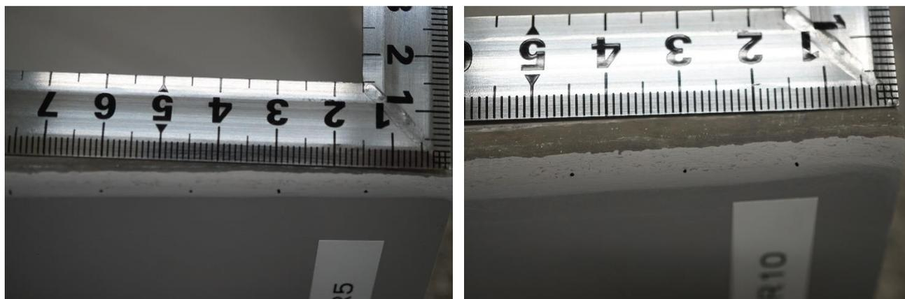
図 R 加工部分の拡大写真（左：Radius machining R5、右：Radius machining R10）
