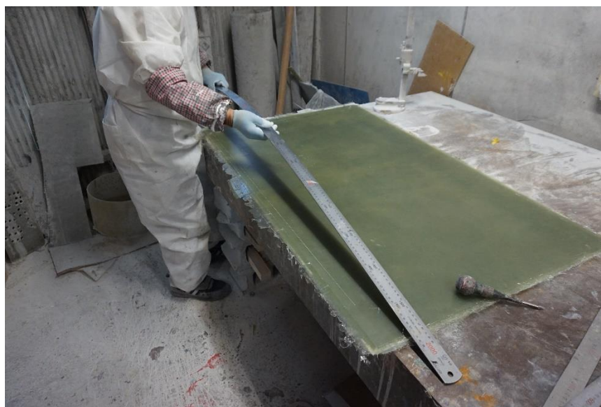
図 FRP 平板成形後、バリ取りのために加工線を入れている様子
