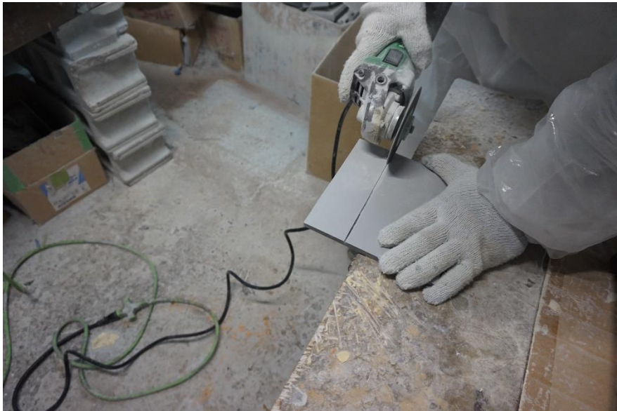
図 FRP 平板加工の様子（上：加工精度確認用 FRP 平板 下：非破壊検査用 FRP 平板）
