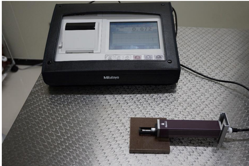
図 表面粗さ測定の様子
