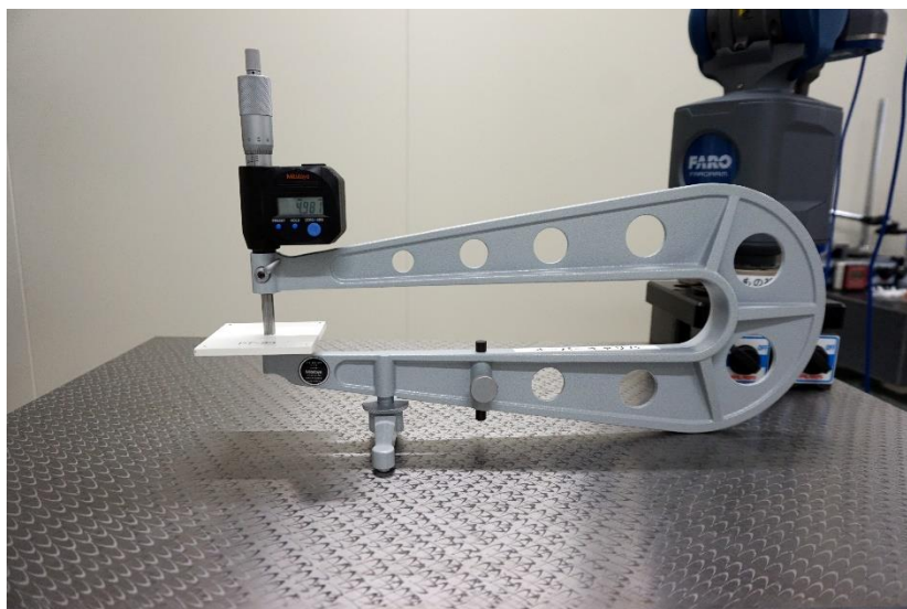
図 板厚計測の様子
