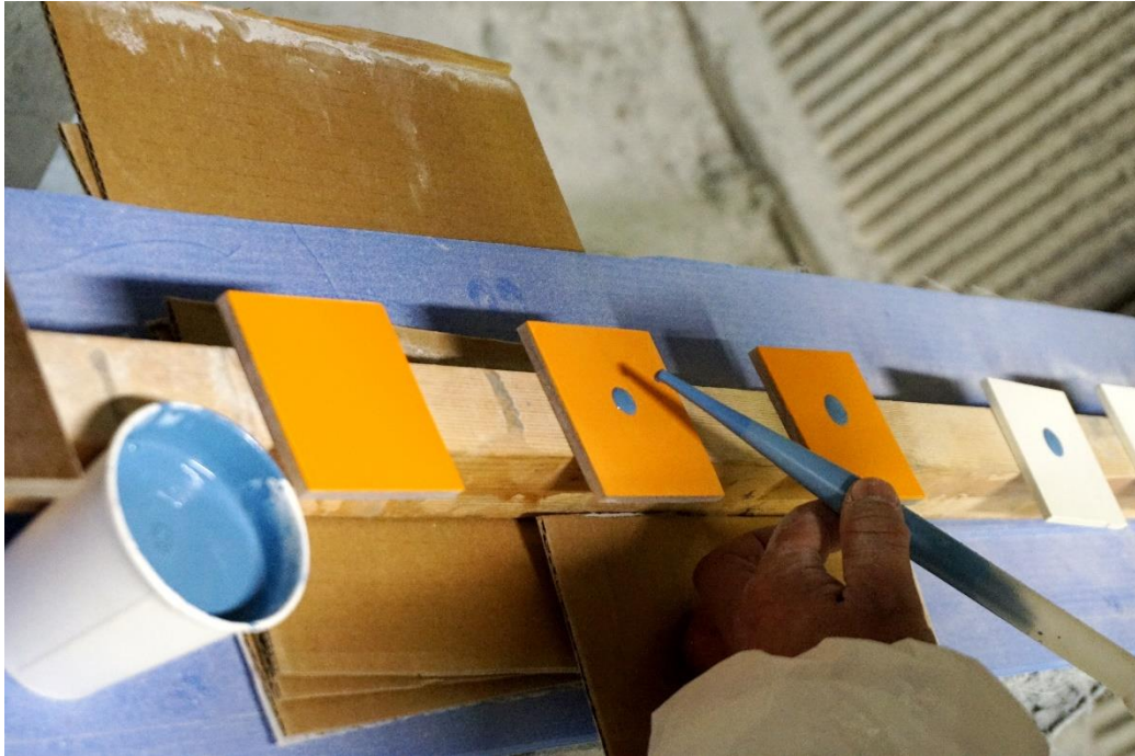
図 塗装接触角/滴下塗装広がり評価サンプル準備の様子
